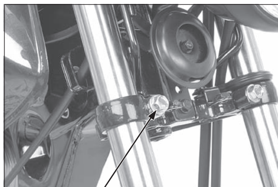
PARAFUSO DE FIXAÇÃO INFERIOR
