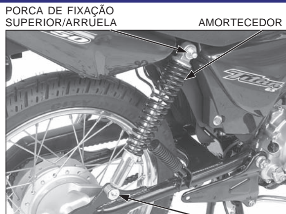
PARAFUSO DE FIXAÇÃO INFERIOR/ARRUELA
