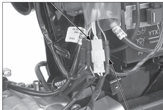
CONECTOR DA FIAÇÃO DO GERADOR DE PULSOS
