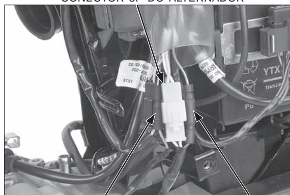
CONECTOR DO INTERRUPTOR DE PONTO MORTO
