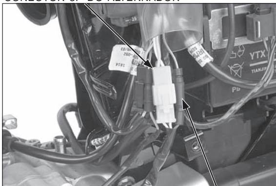
CONECTOR DA FIAÇÃO DO GERADOR DE PULSOS
